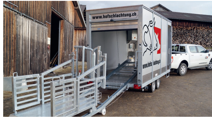
Hoftötung: Anhänger mit Fangplattform als mobile Betäubungsbucht.
